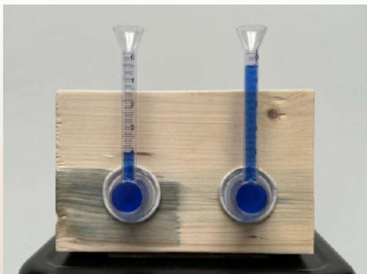
Embora o CLT seja um excelente material, sua principal desvantagem é a suscetibilidade à umidade durante e após a construção. Se não for tratado, pode resultar no crescimento de mofo ou até mesmo em rachaduras na madeira. Para demonstrar os benefícios do uso do nosso revestimento NanoSkin Wood na prevenção desses problemas, utilizamos um tubo Karsten para ilustrar a diferença entre uma superfície revestida e uma não revestida.
