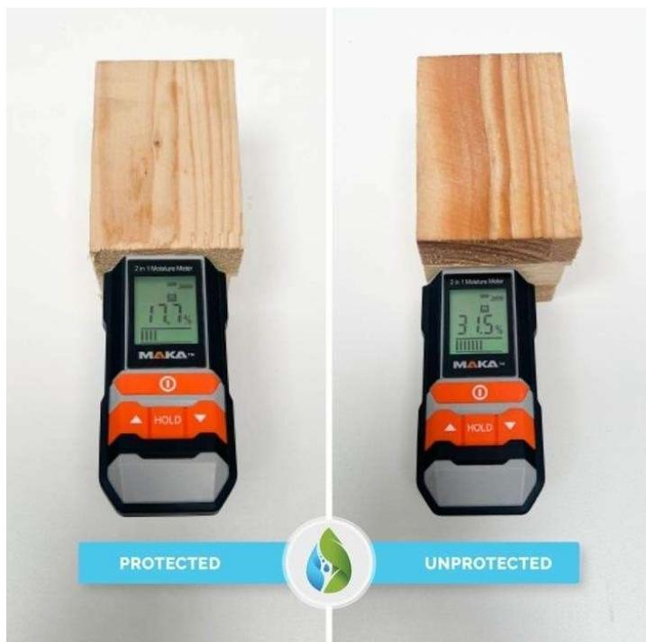
O teor de umidade também afeta o peso do material. Isso tem um impacto significativo, especialmente em construções maiores. O peso da peça revestida aumentou de 311 para 323 gramas (+3,85%), enquanto a peça sem proteção ganhou 37 gramas (+10,45%).
