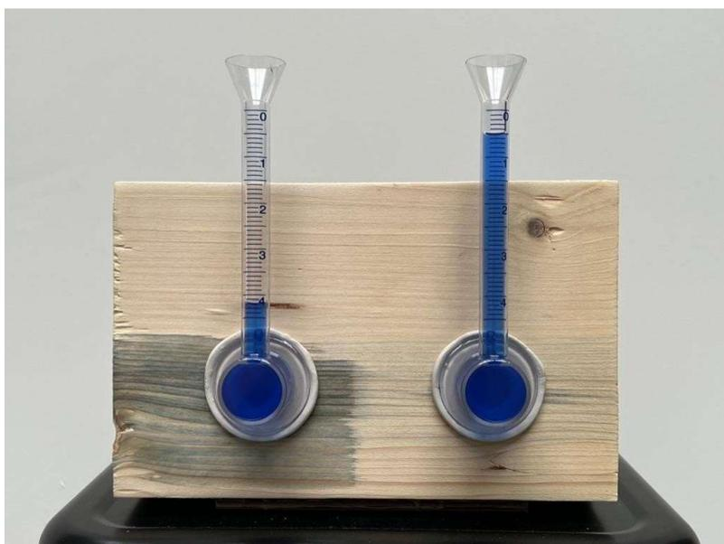
Para ilustrar melhor a diferença, cortamos uma nova peça de CLT ao meio e medimos o teor de umidade, que inicialmente era de cerca de 11% em ambas as peças. Em seguida, mergulhamos a peça em um balde de água por meia hora e a medimos novamente. Os resultados foram claros.
